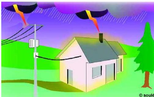
**Les impacts de foudre indirects**, c'est-à-dire lorsque la foudre tombe à proximité d'un bâtiment, on retrouve les surtensions précédemment citées, liées à la montée en potentiel de la prise de terre à l'endroit de l'impact. Les champs électromagnétiques créés par le courant de foudre vont générer des couplages inductifs et des couplages capacitifs, engendrant d'autres surtensions.
